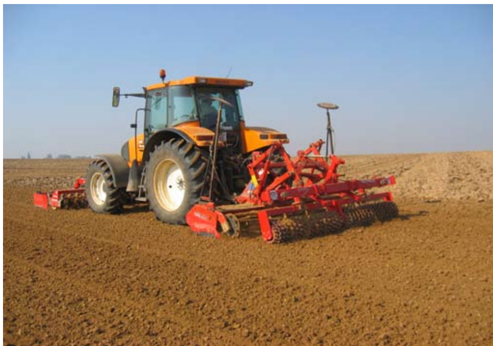
Au printemps, le petit rouleau placé à l'arrière assure un bon "rappuyage" du sol limitant les risques de battance.
